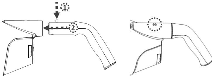
Om de handgreep te demonteren, drukt u de zijpin in en trekt u de handgreep weg.
