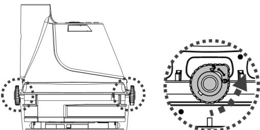
2. Stellen Sie das Oberteil (mit der Unterseite nach oben - der Einschaltknopf zeigt nach oben) auf eine ebene Fläche. Richten Sie die Ladestation aus und schieben Sie den Haken auf die seitliche Nut am Boden des Oberteils, bis es nicht mehr weitergeht. Achten Sie darauf, dass ihre Kontaktplatten einen guten Kontakt haben. Stecken Sie den Stecker des externen Netzadapters in den Ladeeingang am Ende der Ladestation.
