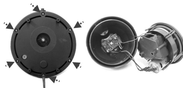
4. Druk op de clip van de connector en trek de connector weg om de voedingskabel van de batterij los te koppelen. NB: wikkel onmiddellijk isolatieband rond de connector om kortsluiting tussen beide kabeluiteinden te voorkomen.
