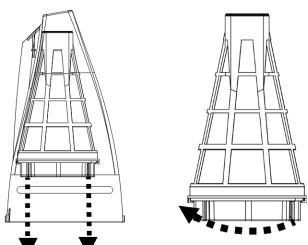
4. Spoel de transparante koker en verwijder het vuil dat zich in de filterkegel bevindt. Het is raadzaam om het gaas van de filterkegel schoon te maken met stromend water. Als dat niet volstaat, kunt u een zachte borstel gebruiken om het vuil voorzichtig te verwijderen. Oefen GEEN druk uit op het gaas.
