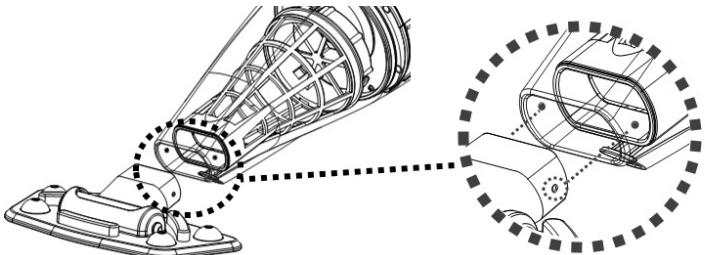
**HINWEIS:** Um die Bürsten am Saugkopf zu erneuern, heben Sie diese am Ende an und ziehen Sie sie heraus, sodass eine neue Bürste angebracht werden kann.
