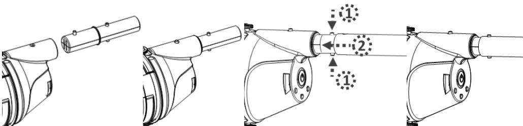
Um die Teleskopstange wieder zu entfernen, drücken Sie die beiden seitlichen Stifte gleichzeitig und ziehen Sie die Stange heraus.
