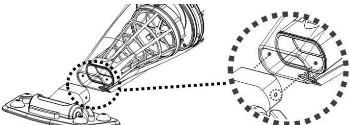
NOTE : Pour remplacer les brosses sur la tête d'aspiration, soulever l'extrémité et la pousser dehors pour laisser un espace pour une nouvelle.
