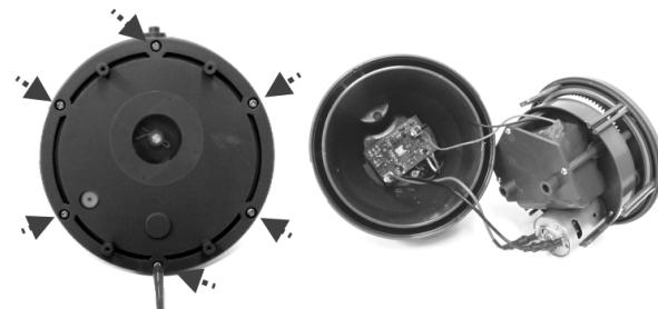
4. Pour séparer le fil de connexion de la batterie, appuyer sur le clip du connecteur et le pousser vers l'extérieur. NOTE : Enrouler immédiatement un ruban isolant sur le connecteur afin d'éviter un court-circuit causé par le contact des deux cosses de câble.
