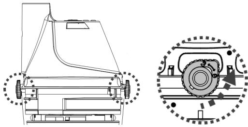
2. Placer le corps arrière (renversé - bouton marche/arrêt face en dessus) sur une surface plate. Aligner et faire glisser le crochet de la base de chargement sur l'encoche latérale au fond du corps arrière jusqu'à ce qu'il s'arrête. S'assurer que leurs plots entrent en contact correctement. Brancher la prise femelle de l'adaptateur externe dans le port de chargement à la fin de la base de chargement.
