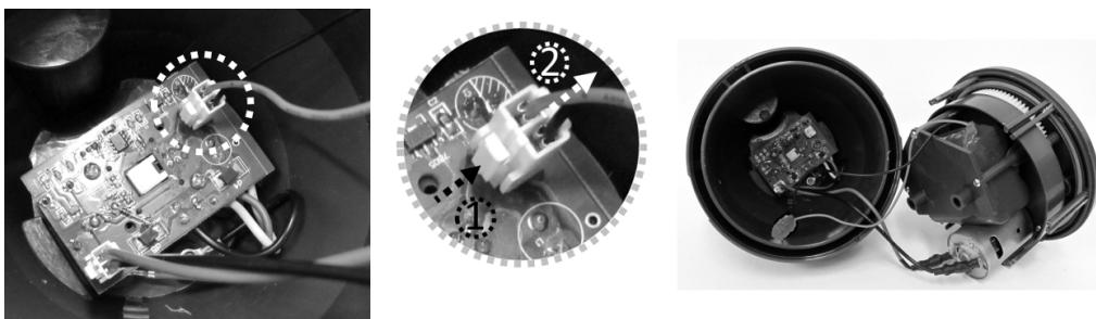
4. Lösen Sie die 3 Schrauben, mit denen die Batterie im Batteriefach festgeschraubt ist. Entfernen Sie das Batteriepaket aus dem Batteriefach.
