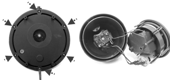
4. Um die Anschlussdrähte von der Batterie zu lösen, drücken Sie auf den Clip auf dem Stecker und ziehen Sie diesen ab. HINWEIS: Umwickeln Sie den Anschluss sofort mit Isolierband, um einen Kurzschluss durch einen Kontakt der beiden Drahtenden zu vermeiden.
