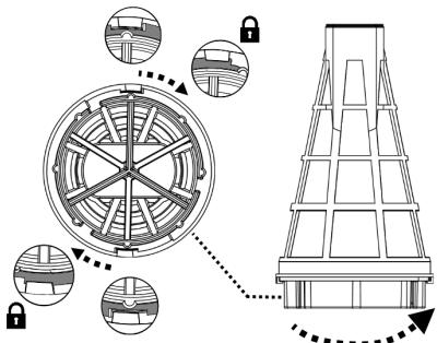
6. Om de transparante koker (met de filterkegel) weer op het achterstuk te zetten, moeten de sluitknoppen aan beide zijden in open positie staan. Zet de bogen aan beide zijden van de transparante koker tegen de sluitknoppen en draai de knoppen met de wijzers van de klok mee tot op de rode stip om het geheel vast te zetten.
