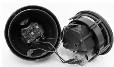
5. Maak de drie schroeven los om het deksel van het batterijcompartiment te openen.
