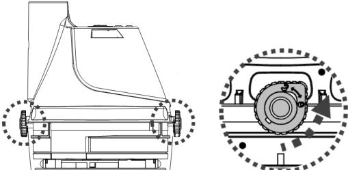
2. Plaats het achterstuk ondersteboven op een vlakke ondergrond, met de aan/uit-knop naar boven. Schuif de haak van de lader volledig in de zijgleuven op het uiteinde van het achterstuk. Controleer of de contactplaatjes elkaar raken. Steek de vrouwelijke jack van de externe adapter in de laadpoort op het uiteinde van de lader.
