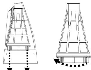
4. Spülen Sie das transparente Gehäuse aus und entfernen Sie den Schmutz aus dem Filterkonus. Es wird empfohlen, das Netz des Filterkonus unter laufendem Wasser zu reinigen. Ist der Einsatz einer Bürste angezeigt, verwenden Sie nur eine weiche Bürste und reinigen Sie es damit vorsichtig. Üben Sie dabei KEINEN Druck auf das Netz aus.
