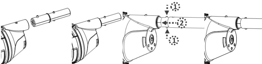
Om de uitschuifbare steel te demonteren, drukt u de twee zijpinnen in en trekt u de steel weg.
