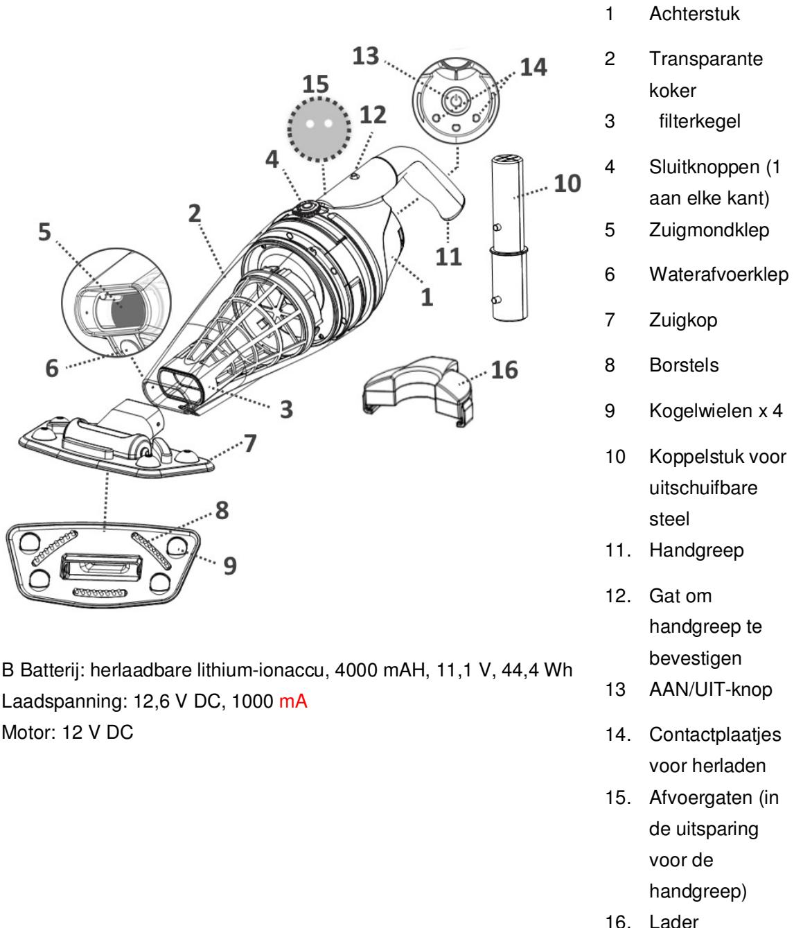
B Batterij: herlaadbare lithium-ionaccu, 4000 mAH, 11,1 V, 44,4 Wh
