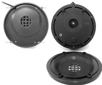
3. Desserrer les 6 vis et séparer le couvercle pour laisser à découvert le PCBA, le groupe moteur et le bloc de batteries.
