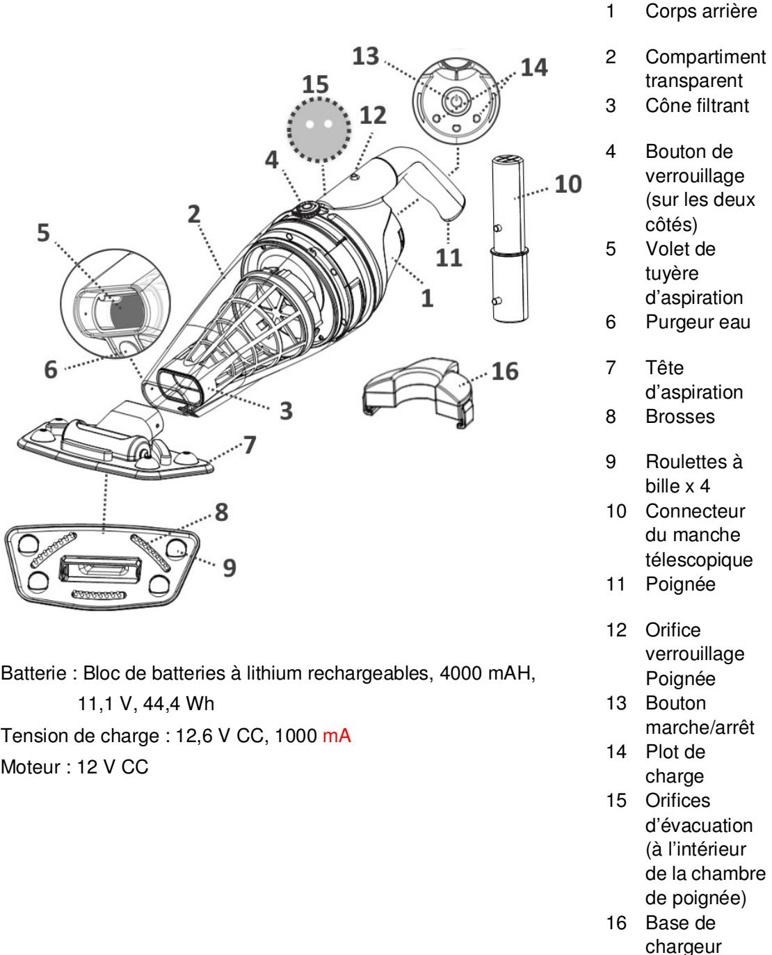
Batterie : Bloc de batteries à lithium rechargeables, 4000 mAH,
