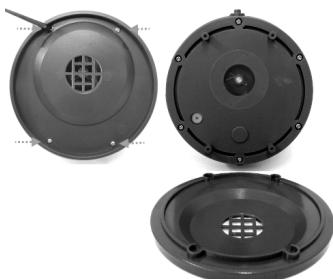
3. Lösen Sie 6 Schrauben und nehmen Sie die Abdeckung ab, wodurch die Elektronik, der Motor und das Batteriepaket freigelegt werden.
